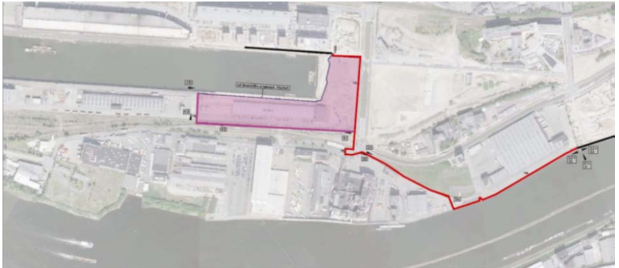
Abb. 46 : Hochwasserschutzlinie (Quelle. Rahmenentwurf Südseite Europahafen)
